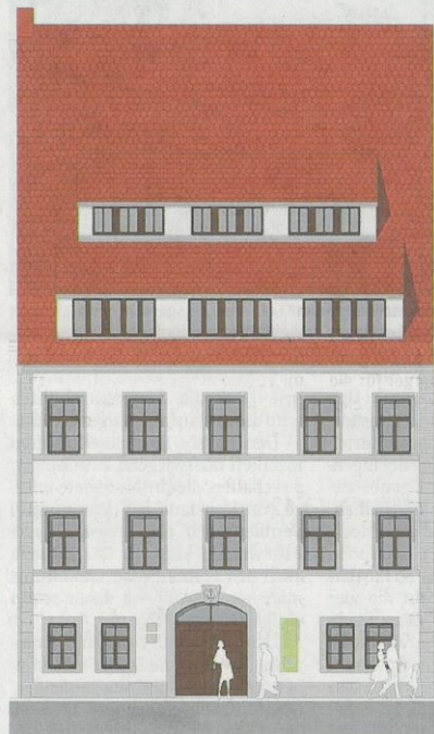
Die Fassade zum Petriplatz hin wird denkmalgerecht saniert. Um dem historischen Bild gerecht zu werden, erhalten dabei erhalten die Gaupen im Dach eine neue Gestaltung.
